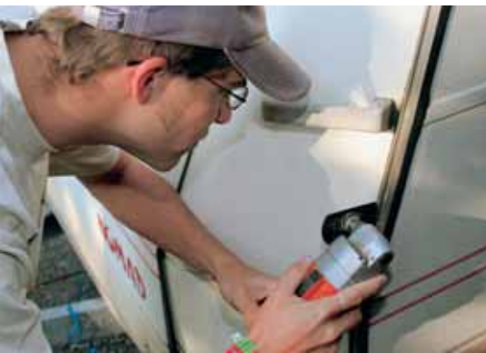
3 Murks ab Werk: In die vernickelten Schraubenköpfe wird ein Schlitz gesägt.
