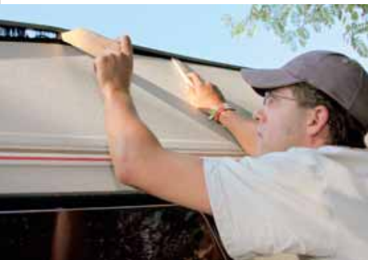
6 Ohne Gewalt: Die heiße Kantenleiste wird mit zwei Keilen von der Seitenwand abgedrückt.
