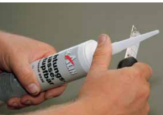
9 Klarer Schnitt: Der Durchmesser der Kartuschenspitze legt die Dicke der Kleberaupe fest.
