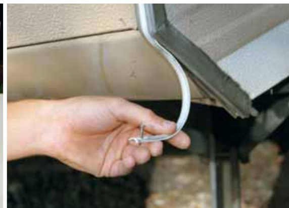
2 Herausziehen: Die Dichtbänder sind am jeweiligen Ende mit Schrauben gesichert.
