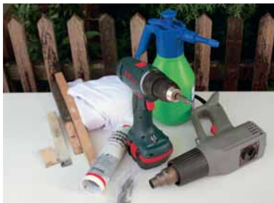
1 Ohne geht's nicht: Keile, Putzlappen, Dichtmasse, Akkuschauber, Silikonentferner in der Pumpflasche, Heißluftfön.
