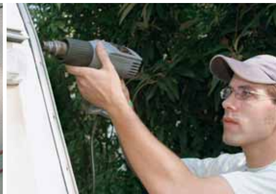
5 Gefühlssache: Die Kantenleiste muss ordentlich aufgeheizt werden, sonst wird der alte Kleber nicht weich.
